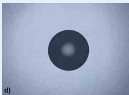
⑤ Reinigung der Steckerstirnflächen mit a) hochreinem Alkohol, b) einer Mikrofaser-Bandkassette und c) mit einem speziellen Reinigungsgerät; das Teilbild d) zeigt die saubere Steckerstirnfläche nach der Reinigung Fotos: bfe-Oldenburg
