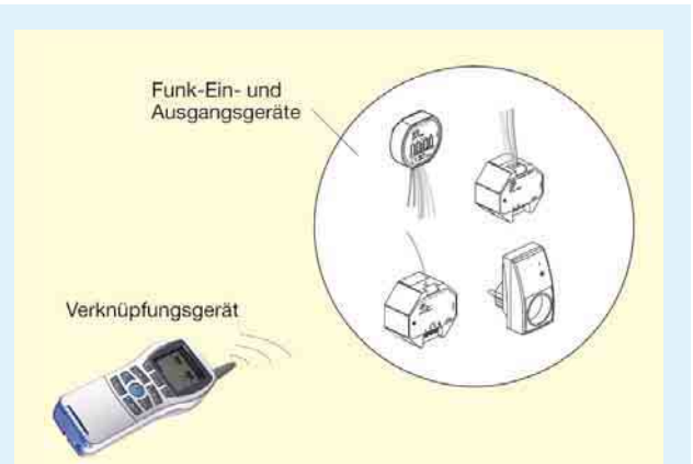
2 Funk-Anlage – Verknüpfung per Handprogrammiergerät
