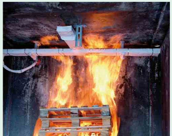
2 Brandversuch – der Dämmschichtbildner beginnt nach ca. 1 Minute auf den Bandagen aufzuschäumen. Durch das beidseitige Aufschäumen ist eine im Brandfall sehr gute Isolierung vorhanden
