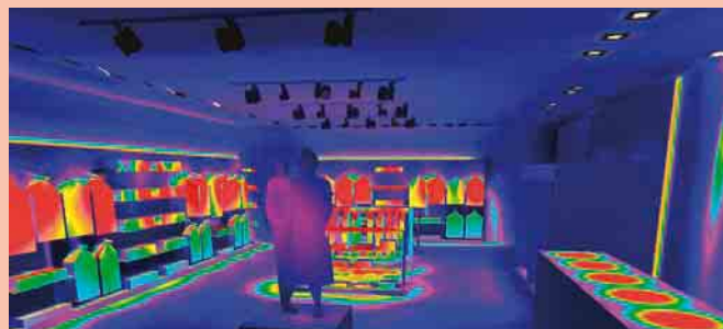
2 Visualisierung einer praxisgerechten Planung des Beispielshops in Falschfarben, die farbigen Bereiche deuten auf höhere Beleuchtungsstärken hin
