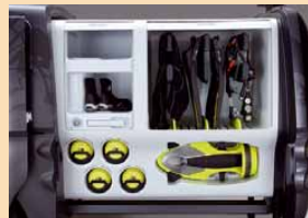
⑤ a, b, c neues Transporterkonzept: Ladeblock mit Schubladen und Fächern fährt aus dem Fahrzeug heraus
