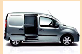
2 a, b Zugang über Doppeltür und seitliche Schiebetüren
