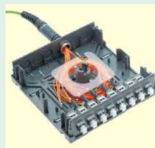
2 Verteilen einer Faser-Optik-Verkabelung
