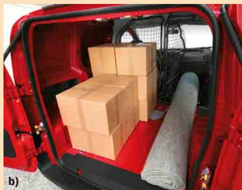
⑦ Zuladung über Heck mit asymmetrischen Türen und seitlich durch Betätigen der Schiebetür
