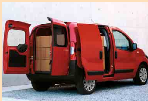
⑦ Zuladung über Heck mit asymmetrischen Türen und seitlich durch Betätigen der Schiebetür
