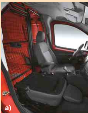
⑥ a, b Durchlademöglichkeit bei versenktem Beifahrersitz
