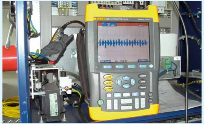
④ Darstellung des Messergebnisses einer Differenzstrommessung bei nicht sinusförmigen Ableitströmen
