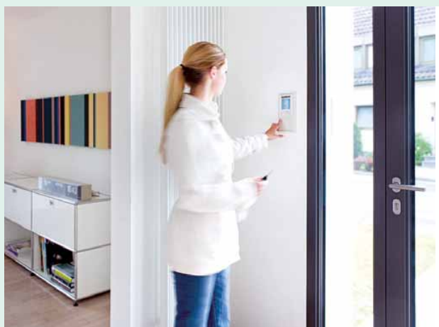
③ Beim Verlassen des Gebäudes genügt ein Tastendruck, um alle ins System integrierten Verbraucher auszuschalten
