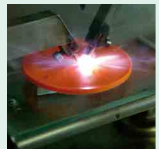
3 Kriechstromprüfung an einem Isolierstoff
