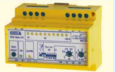
1 RCM (Differenzstromüberwachung) Gerät zum Erfassen/Anzeigen eines Wechselstroms (der Summe/Differenz mehrerer Wechselströme) auf der Grundlage des Erfassens des Magnetfelds des betreffenden Stroms (der Summe/Differenz der Magnetfelder mehrerer Ströme) Quelle: Bender
