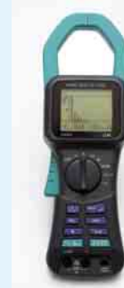
3 Strommesszange Messgerät zum Erfassen/Anzeigen eines Wechselstroms (der Summe/Differenz mehrerer Wechselströme) auf der Grundlage des Erfassens des Magnetfelds des betreffenden Stroms (der Summe/Differenz der Magnetfelder mehrerer Ströme) Quelle: LEM
