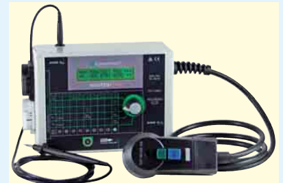
5 Prüfgerät für ortsveränderliche, vorzugsweise steckbare elektrische Betriebsmittel Gerät zum Messen des Schutzleiter- und des Isolationswiderstands und der Ableitströme (Schutzleiterstrom, Berührungsstrom – unterschiedliche Messverfahren) Quelle: GMC
