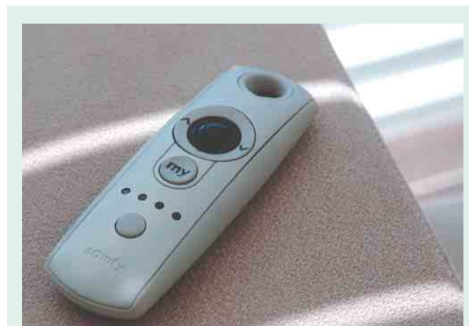
➊ Scrollrad des Handsenders ermöglicht komfortables Einstellen des Neigungswinkels von Außenjalousie-Lamellen
