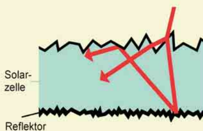
Bedingt durch eine texturierte Oberfläche wird der Weg des Lichts verlängert
