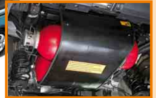
③ a Erdgasbehälter unter Flur
