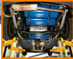
② a Erdgasbehälter unter dem Fahrzeugboden
