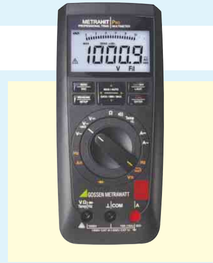
3 Multimeter Metrahit Professionell (GMC) mit einem sogenannten Tiefpassfilter, durch den die das Messergebnis verfälschenden Oberschwingungen herausgefiltert werden
