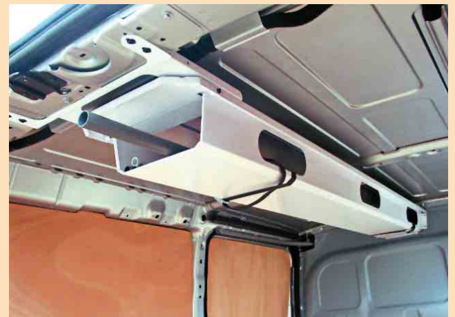
❺ Sehr praktisch: Langgut-Ablage für Rohre oder Kabelschächte
