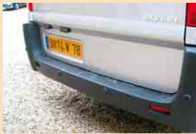
⑦ Praktisch und preisgünstig: Ultraschall-Rückfahrwarner in den Stoßstangen
