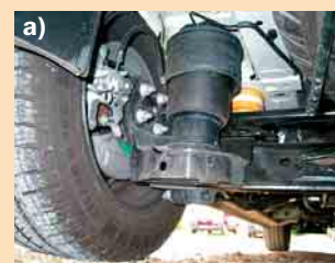
❻ Bei Luftfederung a) das Heck um bis zu 7 cm b) per Knopfdruck absenken
