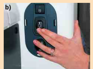
❻ Bei Luftfederung a) das Heck um bis zu 7 cm b) per Knopfdruck absenken
