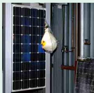
9 Glasbruchtest mit einem 45 kg schweren Prüfsack
