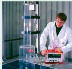
1 Mechanische Belastung im Hagelschusstest
