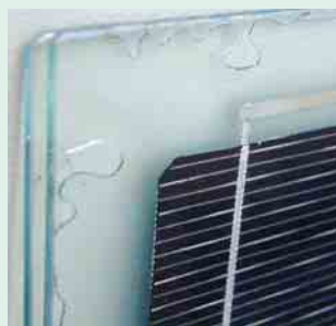
7 Durch Delamination eindringende Feuchtigkeit
