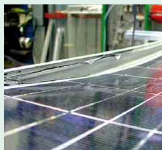
8 Ablösen der Schichten aus dem Rahmen
