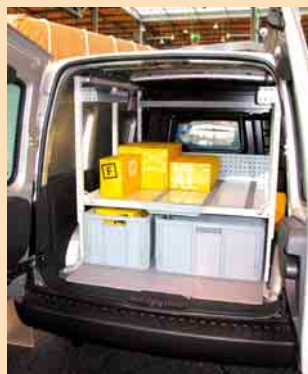
9 a Einfache Lochträger und Bleche für ein Traggerüst im Innenraum Fotos: Domina
