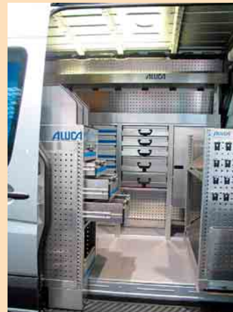
2 Breite Schiebetüren ermöglichen den Zugriff auf den Schubladenschrank auch von außen
