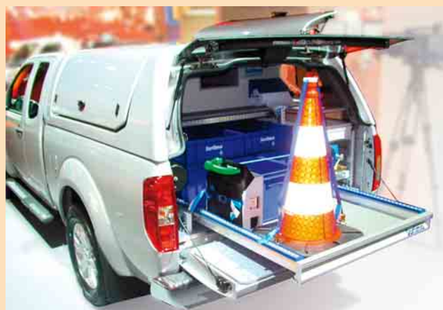
3 Sortimo/Nissan – so kann der Pick-Up leicht be- und entladen werden
