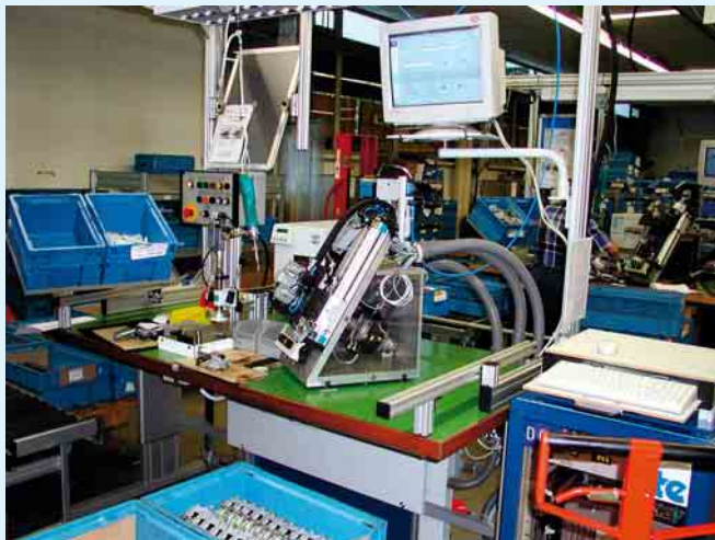
① Prüfnest zur Geräusch- und Funktionsprüfung von Schiebedachantrieben in der Fertigung. Der Antrieb wird an den Originalbefestigungspunkten gespannt. Eine Magnetpulverbremse simuliert die Lastverhältnisse der Bewegungen des Schiebedachs.
