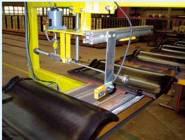
② Prüfnest für eine Rissprüfung an Dachpfannen. Die Anschlageneinheit und das Mikrofon sind direkt über dem Band befestigt. Die Prüflinge werden in der Vorbeifahrt angeregt und klassifiziert.
