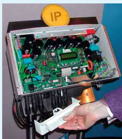
② Im Wechselrichter ist ein elektronischer DC-Lasttrennschalter integriert Foto: Haselhuhn
