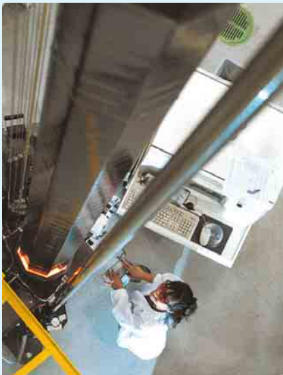
9 Die bandgezogene „Silizium-Oktagon-Technologie“ ist ein besonders wirtschaftliches Verfahren zur Herstellung von Wafern. Foto: Jens Meyer
