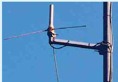
1 Für Funkverbindungen im Freifeld werden unter anderem ortsfeste Rundstrahler eingesetzt Quelle: Luge
