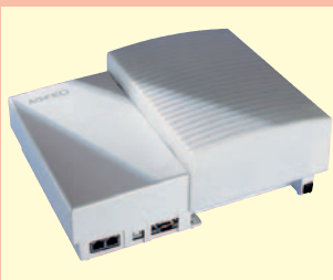
1 Mit einem EIB-Modul wird die TK-Anlage zur Schaltzentrale der Gebäude-systemtechnik Fa. Agfeo
