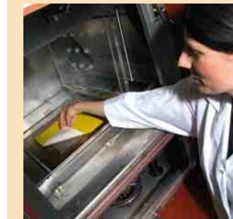
1 Das Hautmodell simuliert Wärme- und Schweißabgabe der menschlichen Haut
