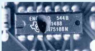
⑧ Aufgeplatzter Chip – typisch bei Überspannungsschäden
