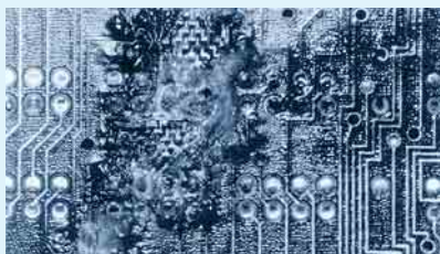
⑦ Zerschmolzene Leiterbahn und Platine auf Grund einer Überspannungseinwirkung oder auf Grund einer Überlastung durch Alterung, Verschmutzung usw.
