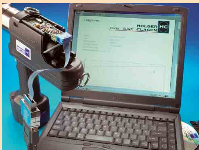
1 Lückenlose Dokumentation der Verpressung und elektronische Versendung des Prüfprotokolls
