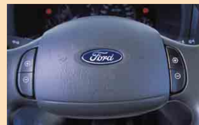
1 Durashift von Ford schaltet automatisch oder per Tastendruck am Lenkrad
