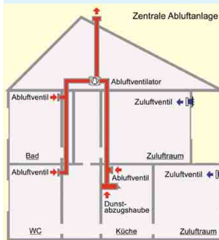
1 Schema einer zentralen Abluftanlage für ein Haus oder eine Wohnung
