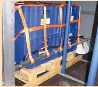
⑥ Rasterschienen in den Regalen integriert sichern die Ladung zuverlässig
