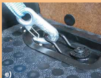
Beim Transit gut befestigt, in sich aber instabil, da stets ein Biegemoment auf die starre Drahtöse wirkt
