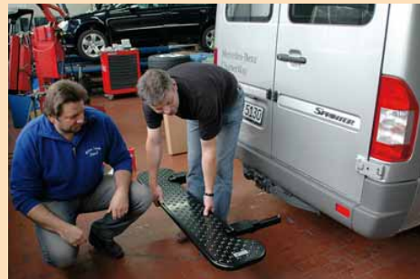
1 Trittstufe des Transit starr montiert, verändert Gesamtlänge des Fahrzeugs
