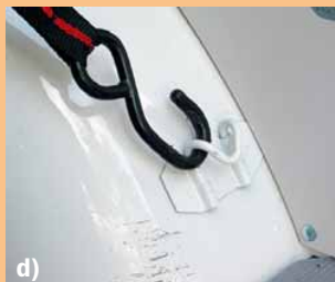
Unbrauchbar – Die „Zurrösen“ des Fiat Scudo – schon bei sanfter Kraf verbiegen sich die starren Drahtösen
