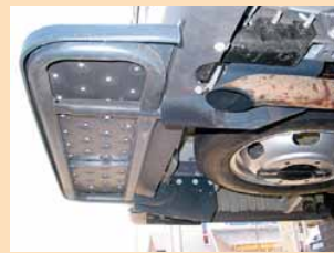
1 Trittstufe des Transit starr montiert, verändert Gesamtlänge des Fahrzeugs
