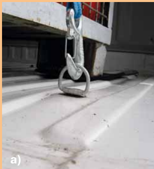
⑧ Peugeot Boxer nur im Bodenblech geschraubt, schon bei geringen Kräften wölbt sich der Blechboden – untauglich!
