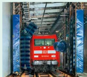
1 Optimale Bürstenposition je nach Zugtyp
