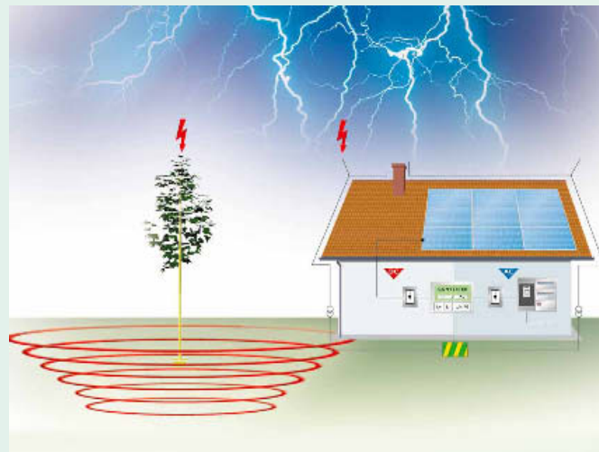
1 Überspannungsschutzgeräte schützen den Wechselrichter, denn auch die indirekte Blitzeinwirkung kann zur Zerstörung der Elektronik führen
