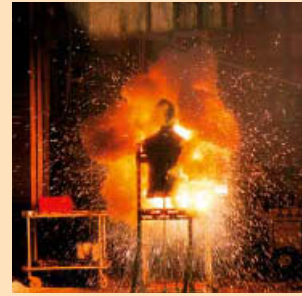
1 Prüfung einer Schutzkleidung im Störlichtbogen
