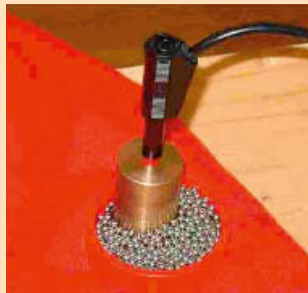
④ Elektrische Wiederholungsprüfung an einer Isolierenden Schutzkleidung
