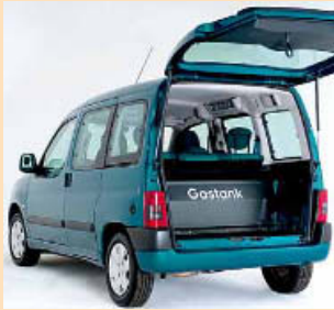
② Beim Citroën Berlingo sind die Gasbehälter im Laderaum untergebracht
