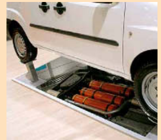
⑤ Fiat Ducato mit unterflur angebauten Gasflaschen
