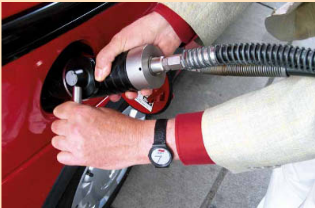
9 Tankvorgang mit Erdgas
