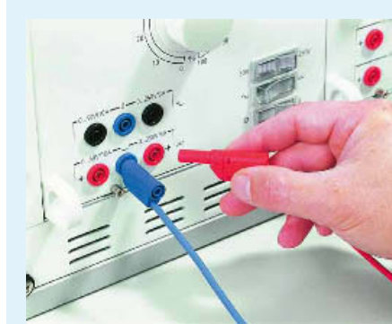
5 Berührungssichere Steck-/Laborbuchsen und Experimentierleitungen
