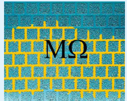
6 Besonderer Bodenbelag zur Standortisolierung
