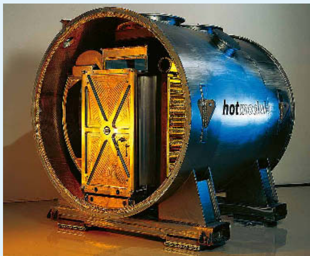
❶ Geöffneter zentraler Stahlkessel mit BZ, eine der drei Baugruppen der HotModule.
