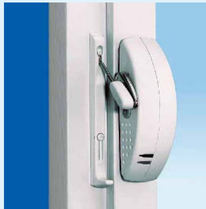
③ Fensterlüftungssystem mit nachrüstbarem elektrischen Fensterantrieb mit Handbetätigung, Fernbedienung und Sensor für automatische witterungsabhängige Steuerung
