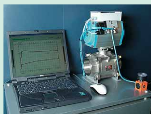
3 Bei jeder Betätigung wird die Drehmomentreserve überprüft
