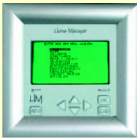
③ Der Funk-Home Manager dient u. a. der Verknüpfung von verschiedenen Komponenten und der Visualisierung
