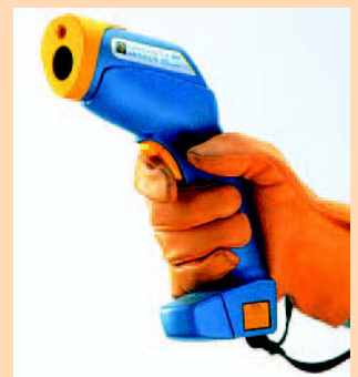
6 Infrarot-Temperaturmessgerät -32°C bis 500 °C
