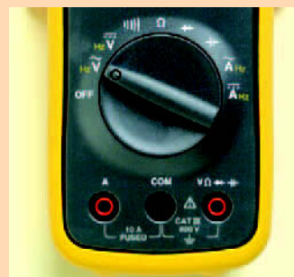
9 Kennzeichnung eines Multimeters mit der Messgeräte-kategorie (CAT III), die den zulässigen Einsatzort (Kurzschlussleistung, Überspannung) bestimmt und die höchste zulässige Bemessungsspannung (600 V) des Einsatzorts
