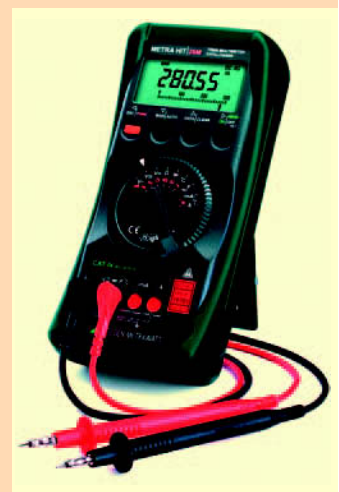
10 Multimeter mit Kennzeichnung CAT IV
