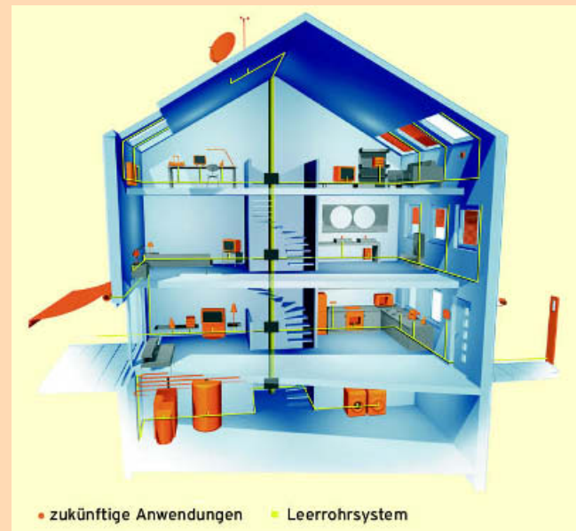
2 Die Mehrkosten für den Einsatz von Leerdosen, Leerrohren und Busleitungen betragen ca. 25 % im Vergleich zur konventionellen Elektroinstallation.
