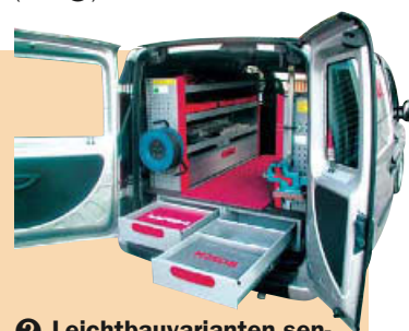
2 Leichtbauvarianten senken den Benzinverbrauch
