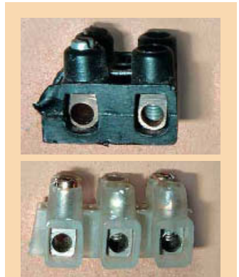
❶ Lüsterklemmen älterer Bauart, die keinen Schutz gegen direktes Berühren aufweisen
