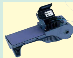
2 Die abgemantelten und gereinigten Fasern werden zum Schneiden vorsichtig in die Faserhalter eingeführt
